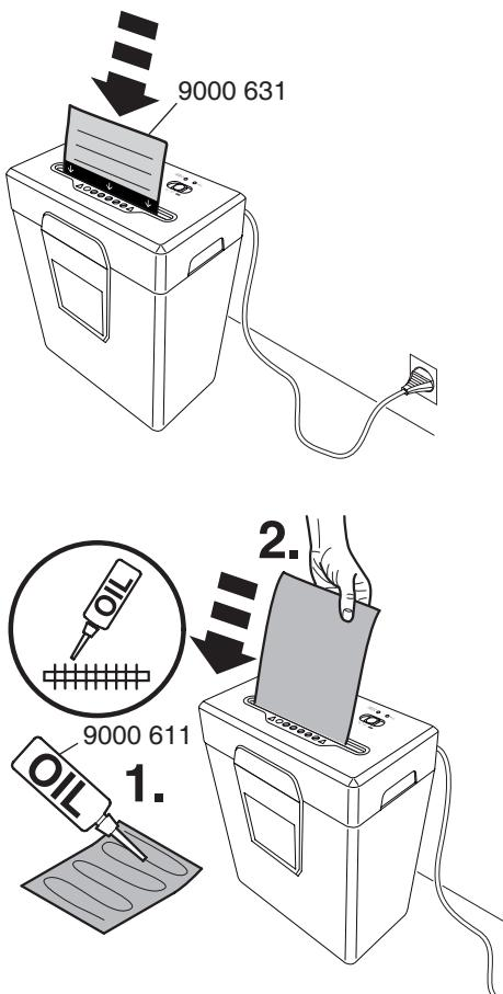
**DE** Bei nachlassender Schneidleistung oder nach jedem gefüllten Papierauffangbehälter Schneidwerk ölen (siehe Bild)! Ölspapier (Best. Nr. 9000 631) oder Spezialöl (Best. Nr. 9000 611) verwenden!
