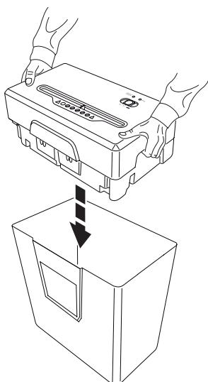
**DE** Maschine in den Auffangbehälter setzen.
