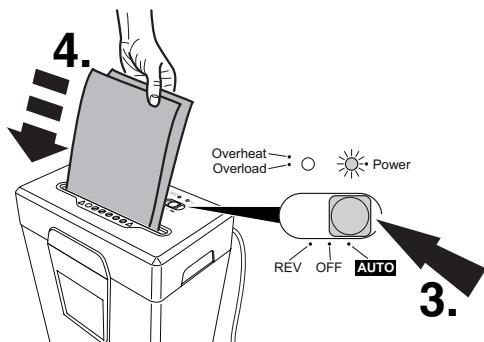
**NO** Stopper automatisk hvis for mye papir er satt inn, Maskinen er blokkert, gul LED for overbelastning lyser.
