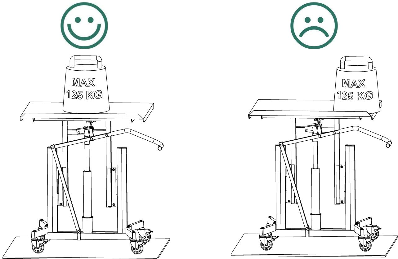
DK-Vær opmærksom på altid at placere belastningen i center af bordet. Respekteres dette ikke, kan det medføre skader i bordets konstruktion, og i værste fald afstedkomme at bordet vælter.
