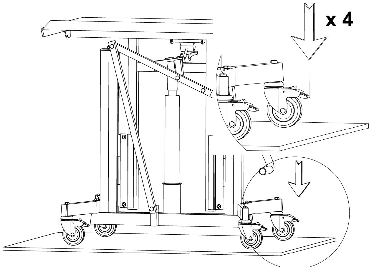
**DK-OBS!** Vær opmærksom på at bordet er placeret på et jævnt underlag, og at alle hjul er bremset korrekt, og i kontakt med gulvet – inden bordet belastes med vægt.
