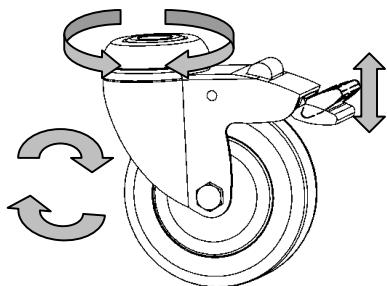
DK-Hjulene tjekkes løbende under brug, tjek at bremsefunktionen virker, at bremsepedalen er i stand til at bremse hjulet, tjek at hjul og hjulgaffel kan dreje rundt. Bruges bordet til at transportere en given belastning, kan defekte hjul være medvirkende til at bordet vælter.
